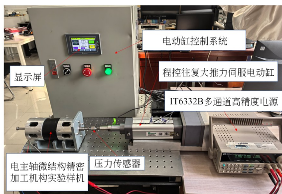
图 19 电主轴微结构精密加工机构推力测试平台
