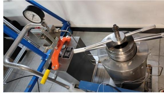
图 6 光纤水听器测试高压腔
