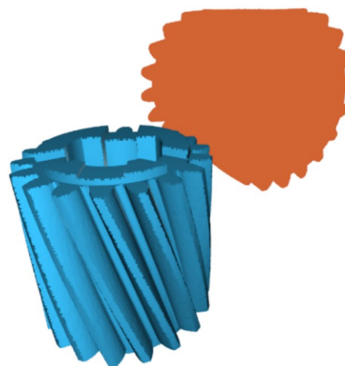
图 4 测量点云与设计点云初始位置
