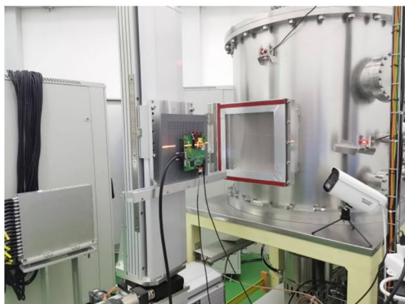
图 13 在线辐照现场装置
