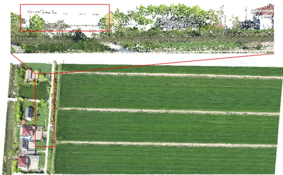
图 11 含噪乡村点云数据模型 Fig. 11 Noisy rural point cloud data model
