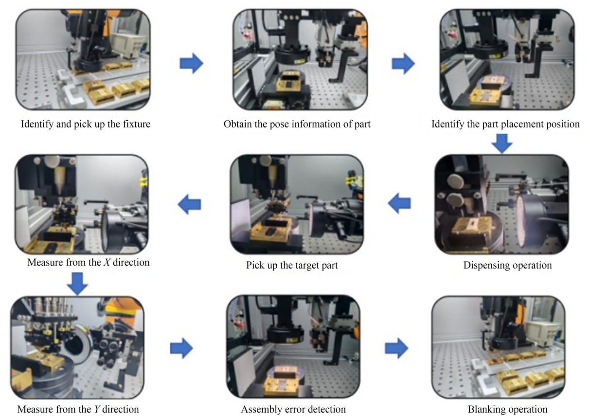
图 8 自动装配的过程 Fig. 8 Process of automatic assembly
