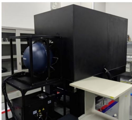
图 9 大靶面相机成像电路测试平台
