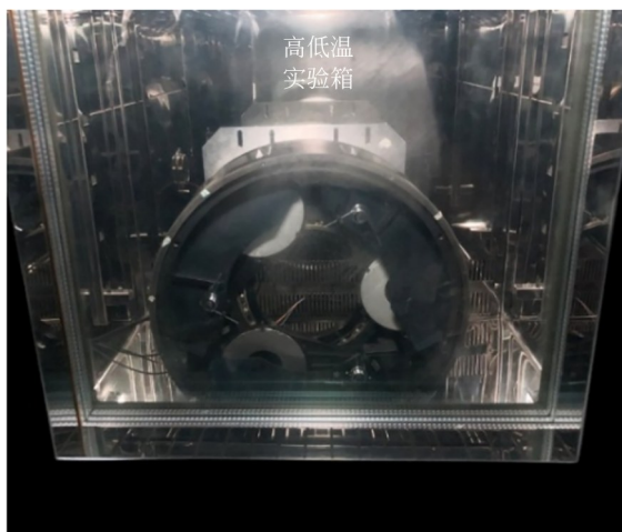
图 14 高低温试验箱内的滤光轮机构
