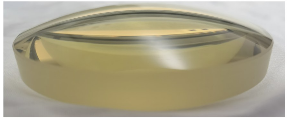
图 17 矢高 9.27 mm、尺寸为 75 mm 的凸透镜 Fig. 17 Convex lens with a height of 9.27 mm and a diameter of 75 mm
