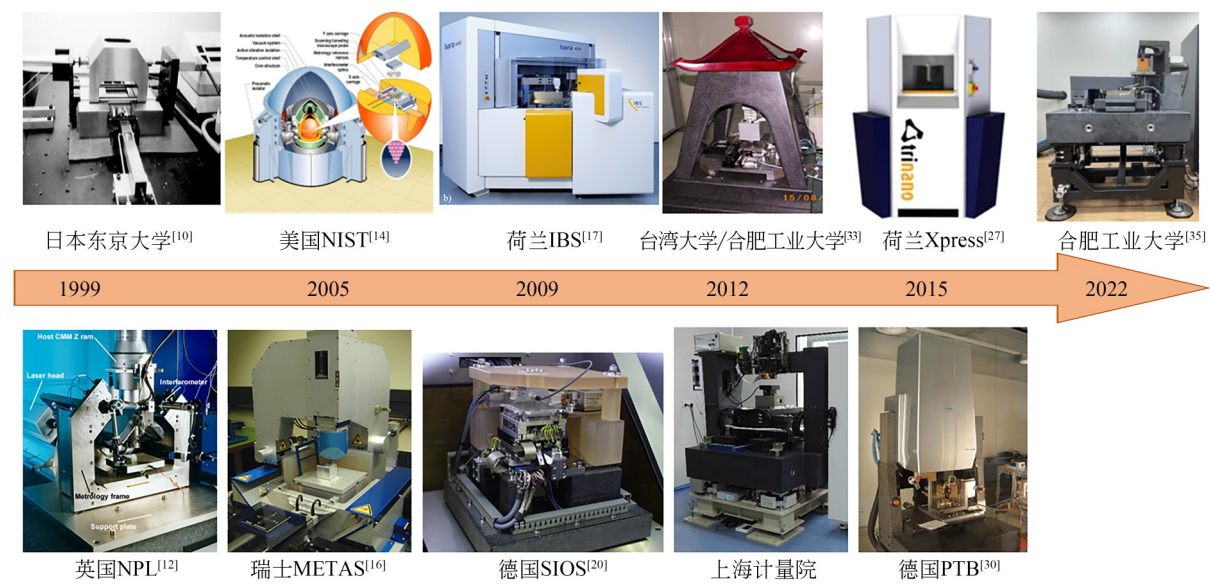
图 1 国内外微纳米 CMM 样机图片
