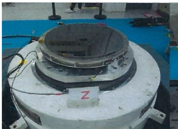
图11 碳化硅双面反射镜振动试验
