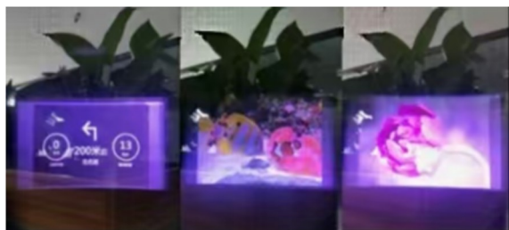
图 13 透射式头戴式显示器样机显示图像
