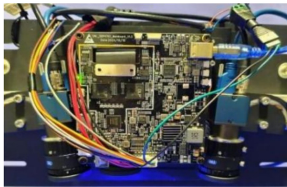
图 7 双目结构光三维测量系统装置图
