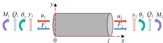
图 1 纵弯耦合状态下单一均质等截面圆形梁两侧的边界条件
