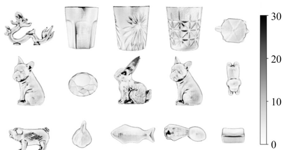
图 14 本文方法在 ThermoPol16 数据集中各样本的法向量角度误差分布
