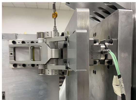
(b) 天线展开到位冲击测试平台
