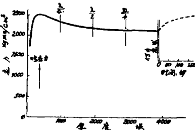
图10 间接辐射加热蒸发的氟化铈，蒸发速率23埃/秒。
