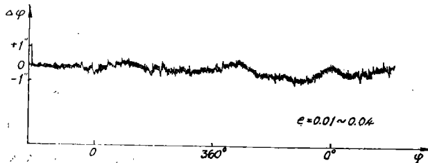
图 5 联轴节随动误差测试曲线: e = 0.01 \sim 0.04 \delta = 0.95
