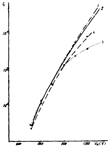
图9 两种MCP电流增益随MCP运用电压的变化. 输入电流作为参量 1—6025 4.81 \times 10^{-14} A 2—6025 6.02 \times 10^{-13} A 3—6025 6.02 \times 10^{-11} A 4— \phi 55.9 mm 5 \times 10^{-12} A
