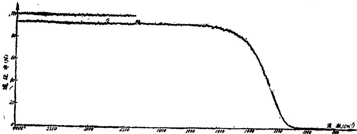
图 7 \text{CaF}_2 晶体，厚 60mm，最高透过率 93%
