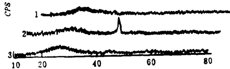
图12 在玻璃基底上, Cu和Al的衍射图
