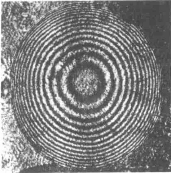
图 3 GRIN 棒切片(厚度 0.12mm)干涉图
