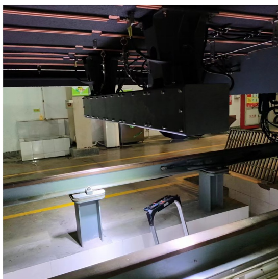
图5 铁路扣件图像采集装置
