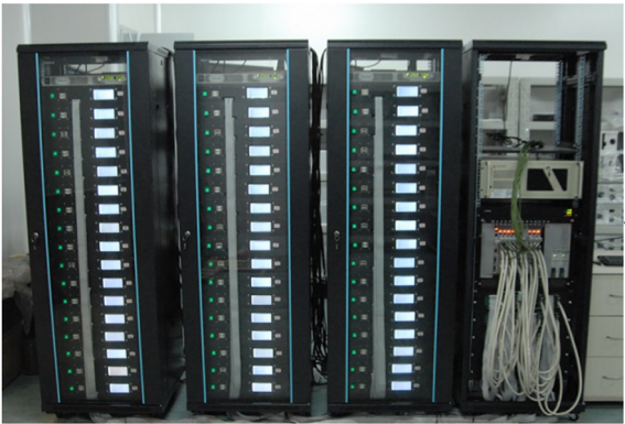
图 12 高压放大系统实验样机布局
