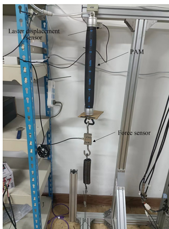
图 18 PAM 力跟踪控制实验平台
