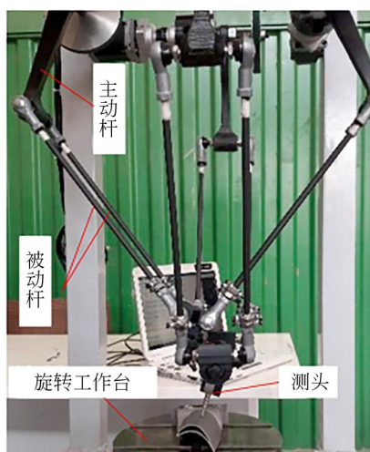
图 11 MAHBOUBKHAH 并联测量机 [13]
