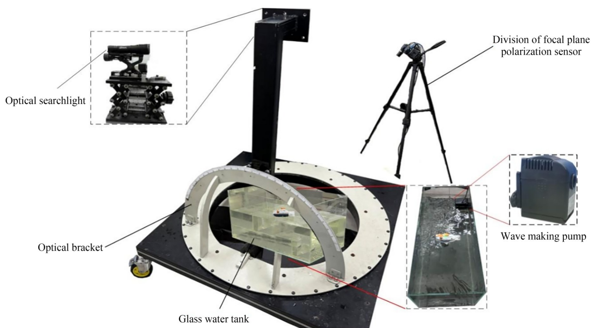
图 5 室内耀光模拟及偏振成像平台
