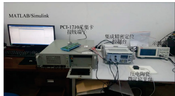
图 4 P11. X100S 型压电作动器实验平台
