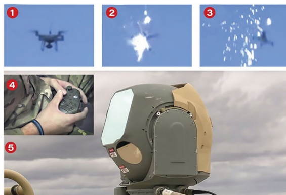
图 7 基于 MTS-B 吊舱改进的 RIS-HEL 车载激光武器光束定向器
