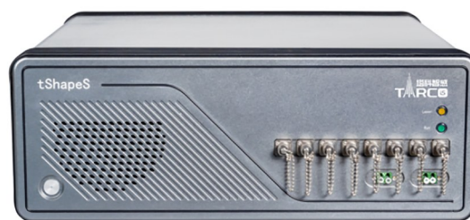
(b) 光频域反射仪的样机 (b) Prototype of OFDR system
