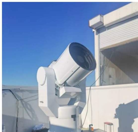
图 3 500 mm 口径同步轨道空间碎片全天时探测系统
