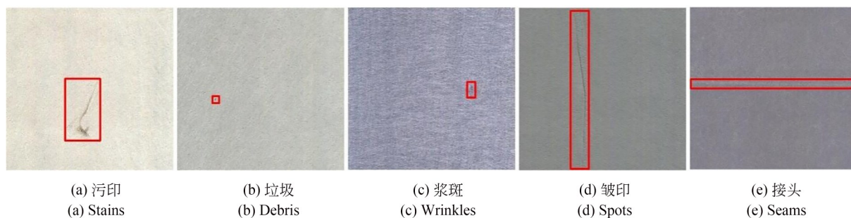
图2 超纤革表面瑕疵图
